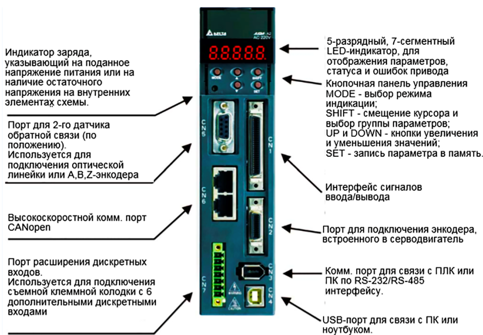
Рисунок 2 – Сервопреобразователь Delta ASD-A20421
